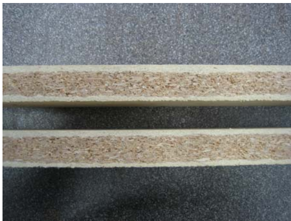
Abbildung 1: a) Querschnitt (Sandwich-Spanplatte); b) Oberfläche (Sandwich- Spanplatte und Referenz- Spanplatte)
