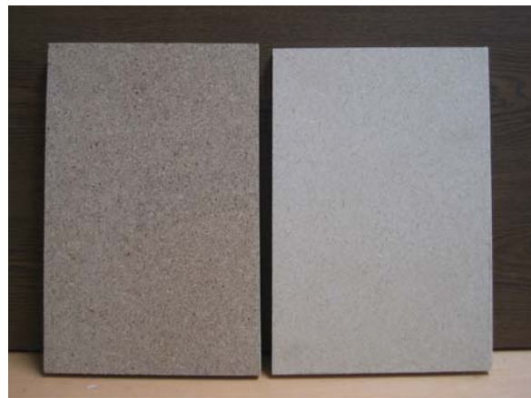
Abbildung 1: a) Querschnitt (Sandwich-Spanplatte); b) Oberfläche (Sandwich- Spanplatte und Referenz- Spanplatte)
