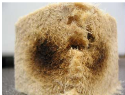
Abb. 9: Buchendämmplatte mit Bereichen thermischer Zersetzung infolge lokaler Überhitzung (Hotspot)
